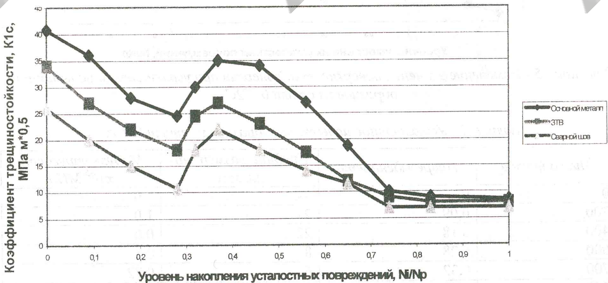
Рисунок 13 - Изменение K_{Ic} стали 09Г2С при усталостных испытаниях в малоцикловой области
